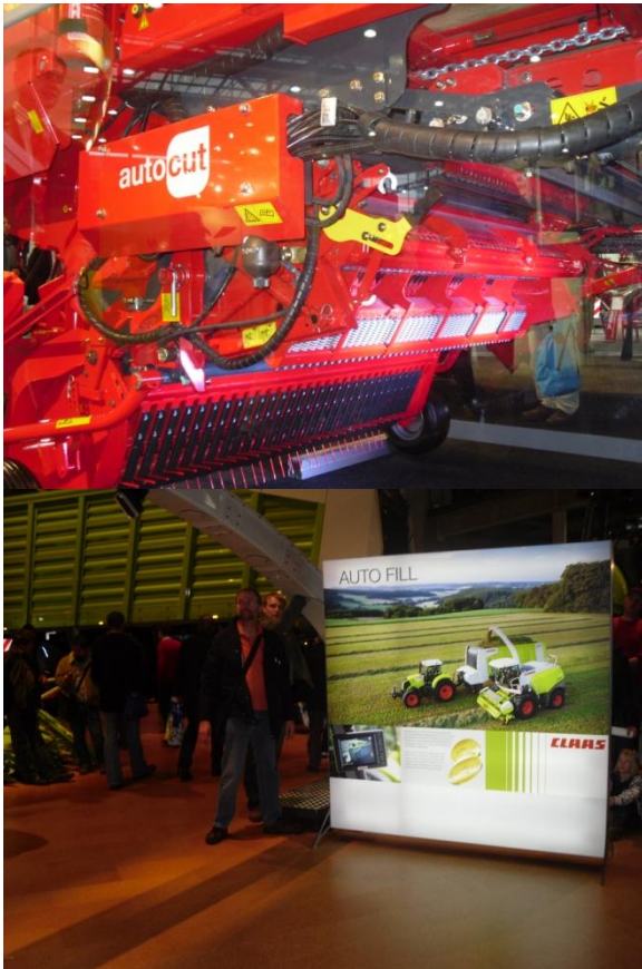
Yllä Pöttingerin noukivaunuun kehittämä automaattinen terien teroituslaite ja alla Claasin näyttelyssä kultamitalilla palkittu AutoFill 3D-kameratekniikkaan perustuva ajosilppurin torven automaattiohjaus.
